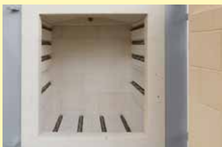
Uppvärmning på tre sidor genom värmeelement som är skyddat placerade i särskilda spår
